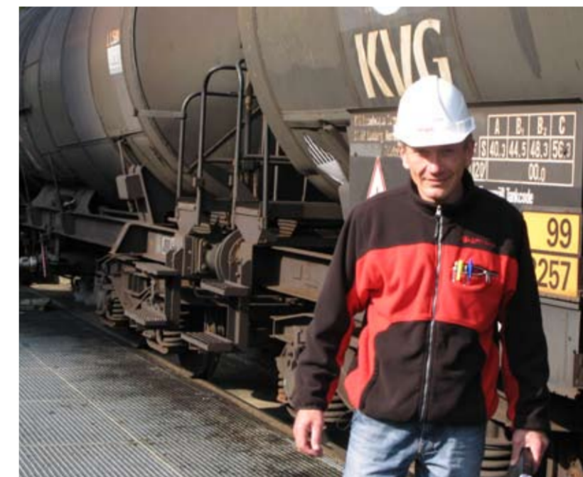
Josef Lackner vor einem Ölzug, pro Waggon kommen 55 Tonnen schweres Heizöl ins Kraftwerk. Das Öl muss zunächst erwärmt und anschließend in die Tanks auf dem Kraftwerksgelände gepumpt werden.
